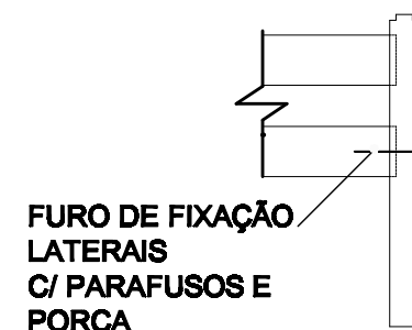
DETALHE - FIXAÇÃO DAS LATERAIS C/ PARAFUSOSE PORCA ESCALA 1/20
